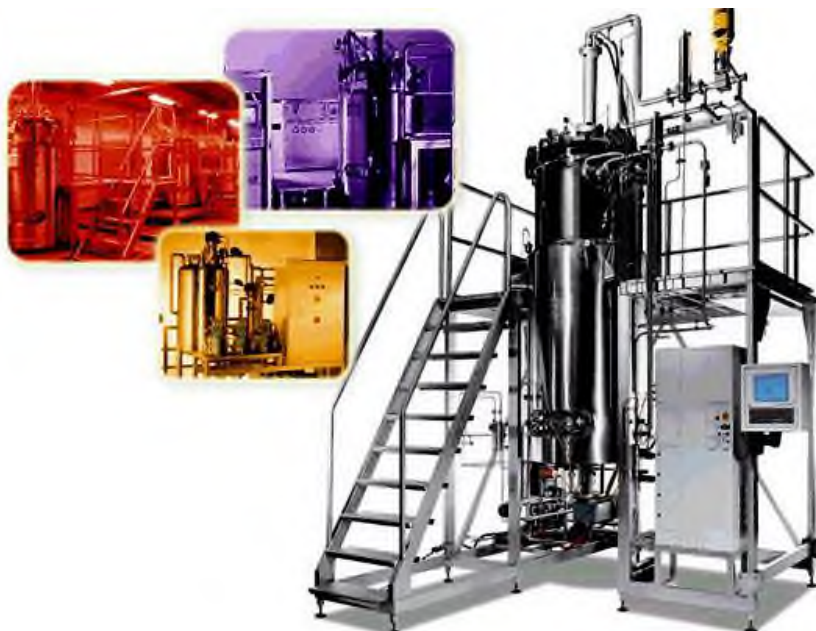
Hình 3.9. Lên men bằng phương pháp nuôi cấy chìm trong môi trường lỏng ở quy mô pilot (200 L)
